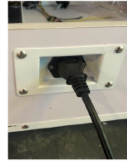
步骤七：插好电源线 通电即可
