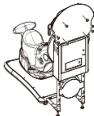
(7)将文字PVC与装饰板亚克力放置定位后,使用指定螺丝锁附.
