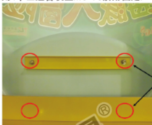
第二步：将灯箱框体放置定位后，用4个三组合机丝M6*16锁附固定。
