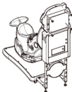
(6)将灯箱维修门放置定位后,锁附固定.
