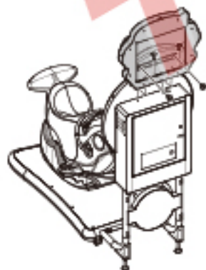
(5)将灯箱框体放置定位后,使用指定螺丝锁附固定.
