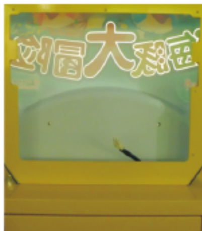
第三步：将灯箱电源线插上
