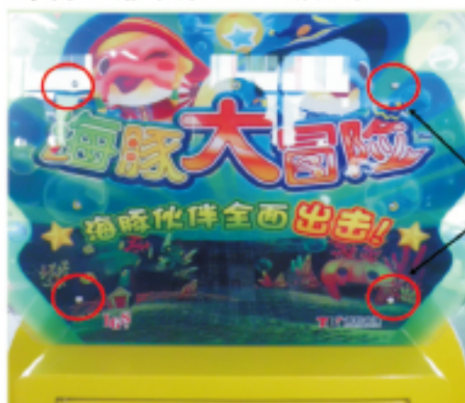
第五步：将装饰板亚克力放置定位后，用4个内六角螺钉M4*12锁附固定。
